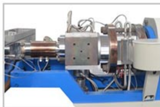
计量泵 自动换网 Melt pump & Auto Screen changer
