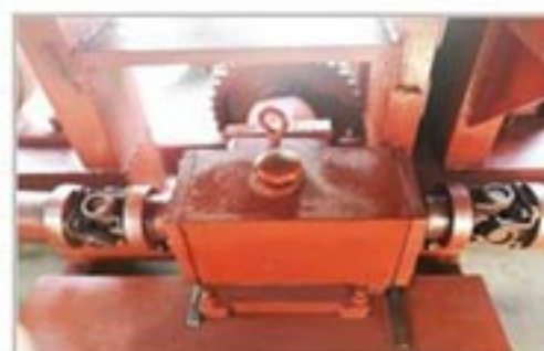
万向节连接传动 Universal joint connect and drive 传动灵活可靠，运转平稳，无振动及打滑现象，噪音低， 节约能源，单位时间内电消耗低。
