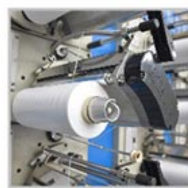
高速变频 卷绕 (450m/min) High speed inverter winder (450m/min)
